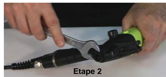
Positionner le pistolet canon vers le haut et récupérer le ressort et la vanne d'air. Si les pièces ne tombent pas, tapoter dans la paume de la main
