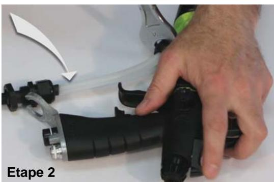
**Pour le remontage,** visser l'écrou inférieur du tuyau peinture jusqu'en butée. Positionner le contre écrou du presse étoupe au dessous de l'équerre, le presse étoupe au-dessus dans l'empreinte hexagonale. Serrer le contre écrou du presse étoupe sur l'équerre.
