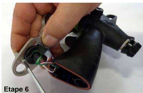
**Pour le remontage, procéder en sens inverse.** Remettre l'ergot du connecteur dans le détrompeur de l'embase et revisser la connexion à la terre. Enduire de graisse diélectrique les joints du mamelon d'air. Serrer le mamelon d'air au couple de 1,5 N.m. Serrer les deux vis (K35 x 14) au couple de serrage de 1,3N.m.
