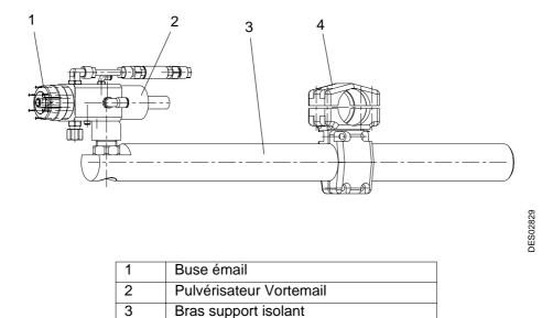
Le pulvérisateur Vortemail possède deux arrivées d'airs de pulvérisation, un pilotage pointeau, et deux arrivées produit (eau et émail). La mise à la haute tension se fait par le produit.
