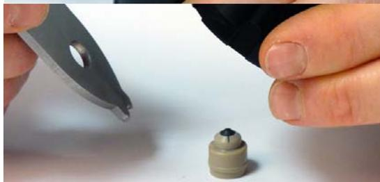
Si es necesario, sustituya la junta del cabezal.
