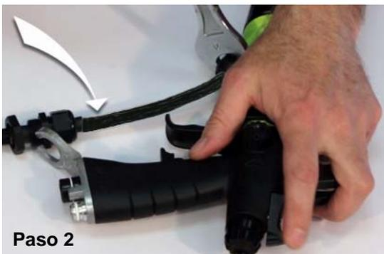
**Para volver a montarlo**, atornille la tuerca superior del tubo de pintura, hasta el tope. Posicione la contra tuerca del prensaestopa debajo de la escuadra, y el prensaestopa superior en la huella hexagonal. Apriete la contra tuerca del prensaestopa sobre la escuadra.
