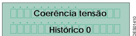
4.2.1.5. Exibição da tensão e da corrente de alta tensão quando o gatilho é activado. Quando a alta tensão estiver activa, o ecrã exibirá, por exemplo, 50 kV de tensão e 45  $\mu$ A de corrente.
